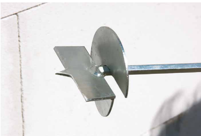
Na vytvoření kapsy použijeme plochý vrták.
